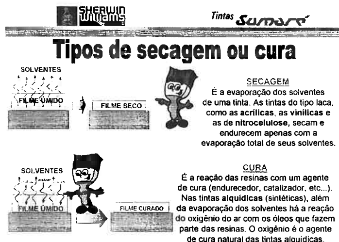
Figura 19 – Tipos de secagem ou cura. Gentilmente cedida pelo Eng.o Celso Gnecco da Sherwin Williams / Divisão Sumaré Tintas.
